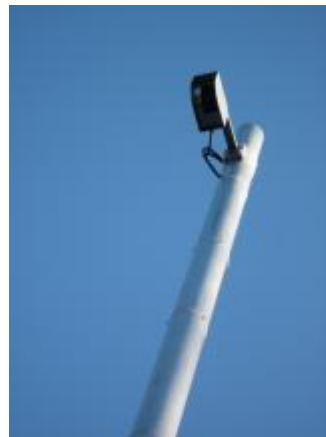
Abbildung 1: Bodenradar "GroundSens" des V&R-Systems und Scanner "ScanSens-X0"
