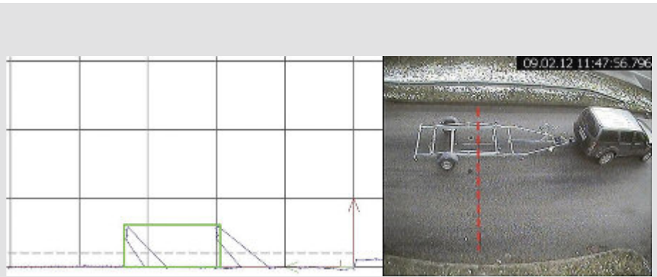
Bild 6: Scanprofil Pkw mit Anhänger
