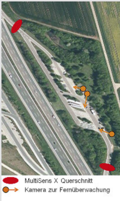
Bild 10: Standort PWC Offenbau mit MultiSens X Querschnitten und Kameras zur Fernbeobachtung
