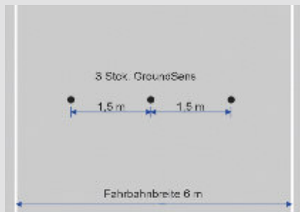
Bild 3: Anordnung GroundSens in der Fahrbahn
